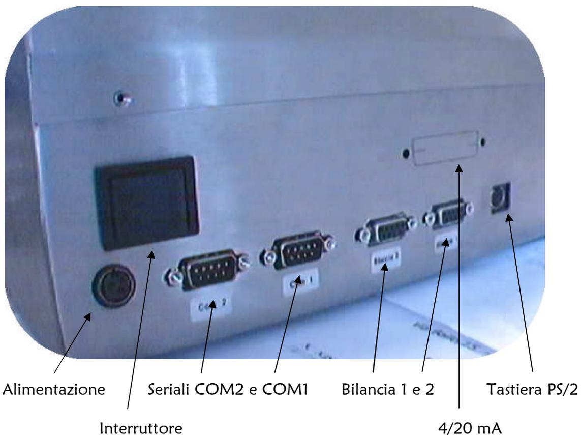
Tutti i cavi di collegamento devono essere dotati di schermo che verrà quindi collegato a terra solo ad una delle due estremità (come indicato negli schemi). Il cavo non deve essere incanalato con altri cavi (es. uscite collegate a teleruttori o cavi di alimentazione), ma deve possibilmente seguire un proprio percorso. Per quanto riguarda le connessioni logiche è bene dotare di filtri i teleruttori e di diodi sui relè a 24V. La lunghezza dei cavi deve rispettare i seguenti parametri:
