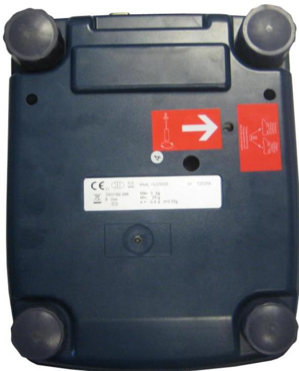
c) **Livellare la piattaforma** agendo sui piedini a vite fino a che la bolla di livello non è al suo centro. Riveste molta importanza la stabilità della piattaforma.
